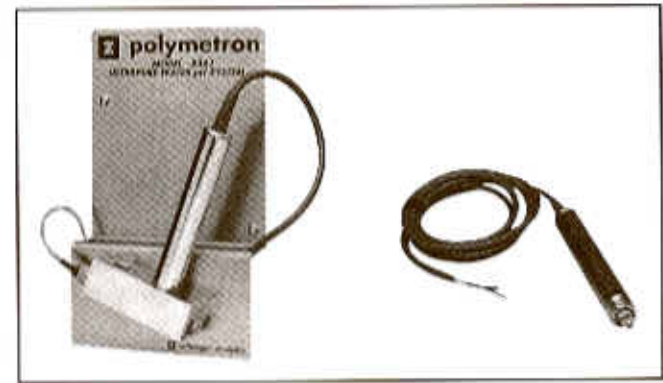
รูปที่ 18 ชุด pH electrode สำหรับวัดค่า pH ของน้ำบริสุทธิ์โดยเฉพาะ (จาก catalogue ของบริษัท Polymetron)
